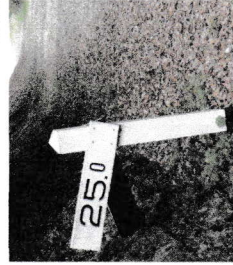
↑ カープの外側で遠心力によるレールのズレを測定した基準器の残骸が所々に出ています
